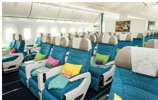
CLASSE MOANA ECONOMY : • 232 sièges • Configuration 3-3-3 • Pitch de 79 cm • Ecrans HD tactiles 30cm • 1 prise USB • Franchise bagages : 1 bagage de 23 kg en soute + 10 kg en cabine + effets personnels (ordinateur et sac à main par exemple) • Equipements de confort : Grande couverture polaire - coussin confortable - trousse complète d'accessoires.
